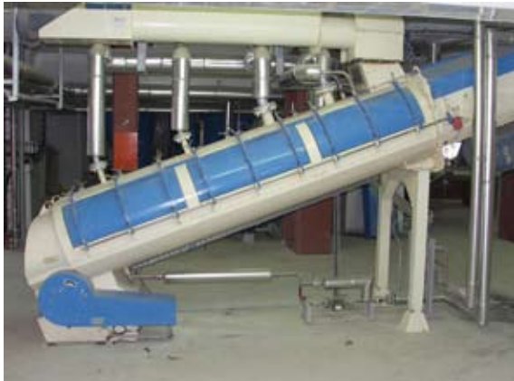
Conditionneur thermique en préparation sur presse
