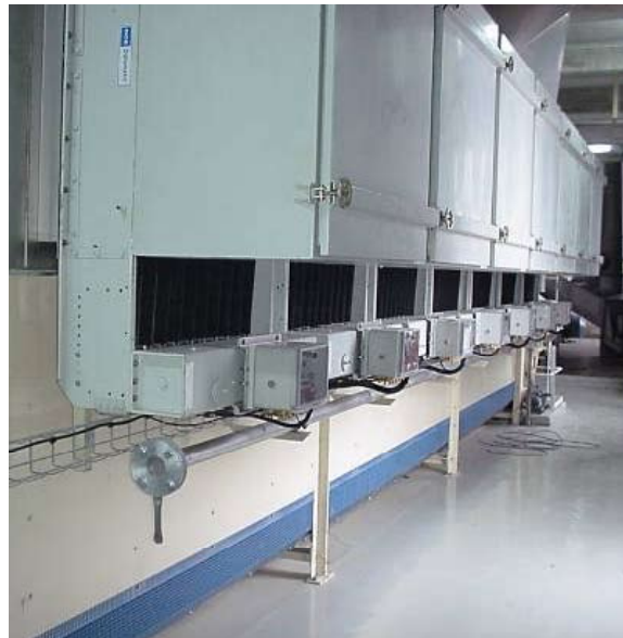
Refroidisseur à 2 passages équipé de filtres
